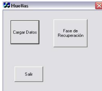
Figura 5.5 Pantalla del menú principal del Identificador de Huellas Digitales Una vez que se leyeron los archivos se procede a la fase de recuperación haciendo clic en el botón “Fase de Recuperación”. La pantalla que aparece se muestra en la figura 5.6.
