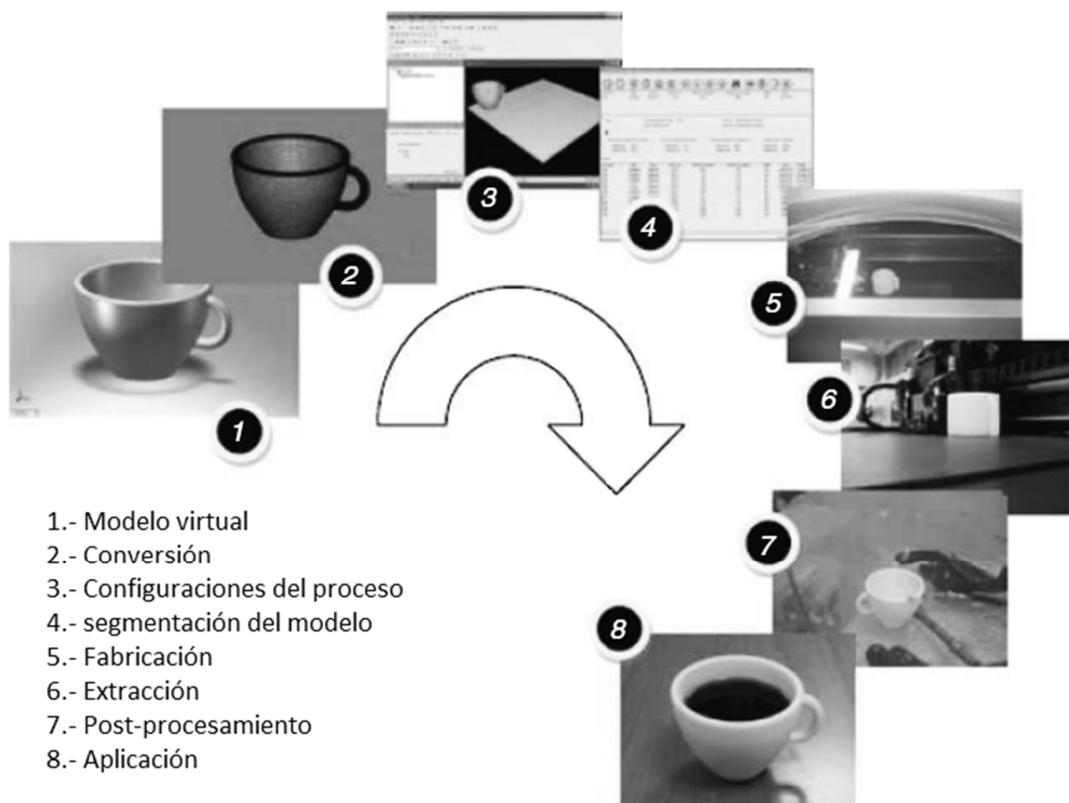
Figura 1 Proceso genérico de la manufactura aditiva [1].
