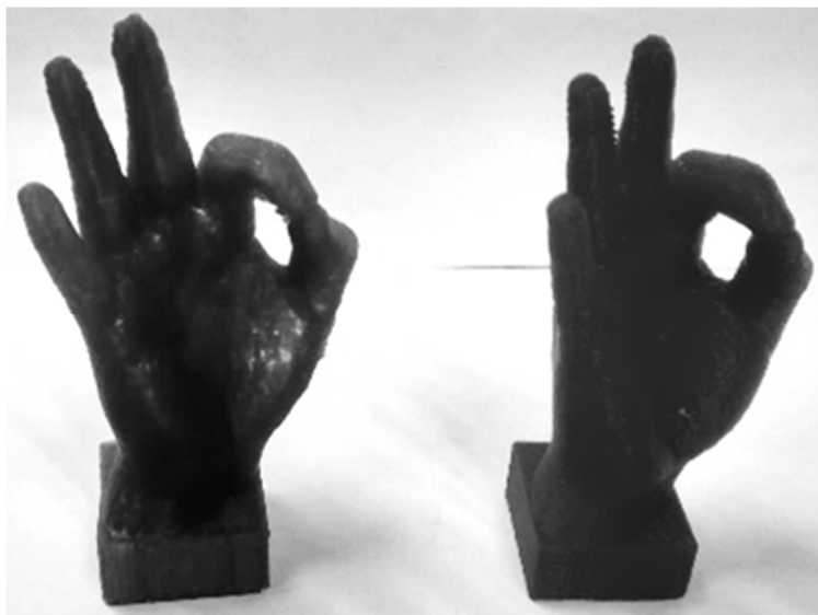
Figura 74 Mano. ReplicatorG (izquierda) inyección dispar (derecha).
