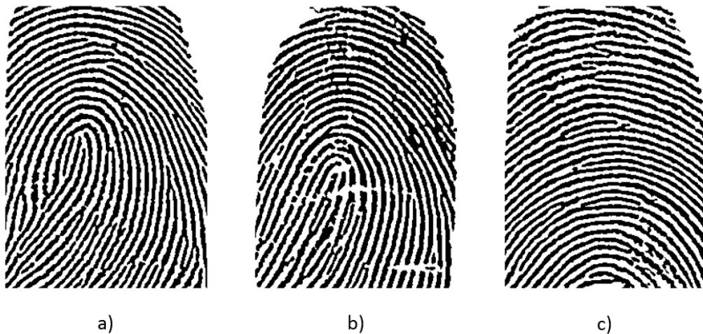
Figura 30 Aplicación de la binarización adaptativa a imágenes previamente mejoradas con la TDF y ecualización del histograma mostradas en la Figura 29.
