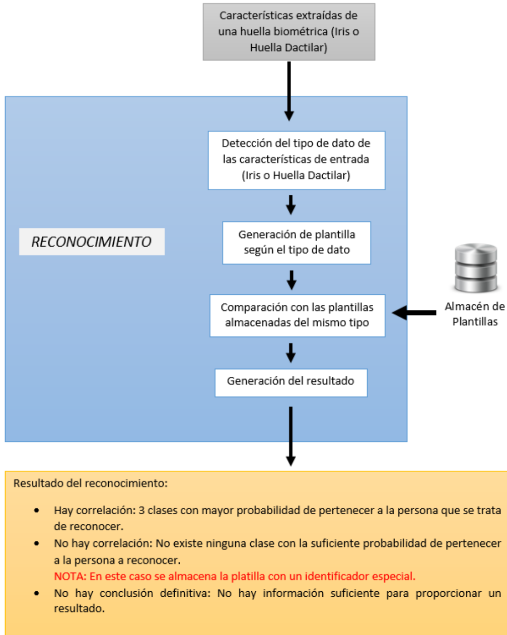
Figura 37 Diagrama 2 del subproceso de reconocimiento de características extraídas de una huella biométrica (Iris o Huella Dactilar)
