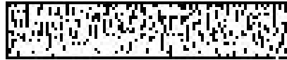
Figura 33 Código de iris generado a partir del preprocesamiento de una imagen de un ojo.
