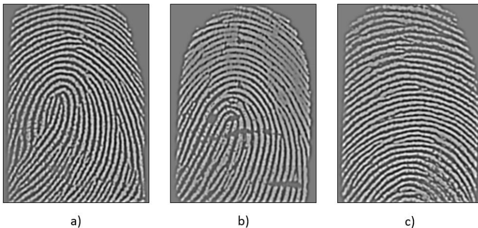
Figura 27 Transformada de Fourier aplicada a las imágenes de la Figura F1.
