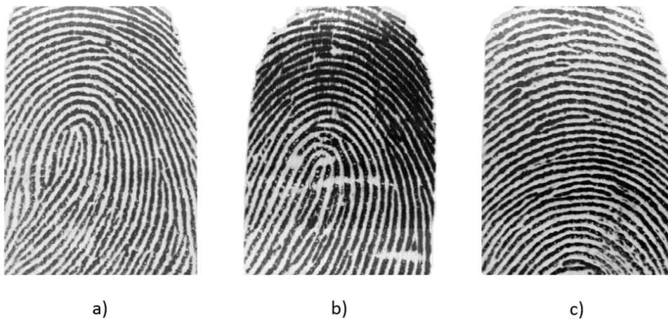
Figura 29 Imagen que refleja la segmentación aplicada sobre las imágenes originales de la Figura F1, donde se puso en blanco las zonas que no pertenecen a la huella dactilar.
