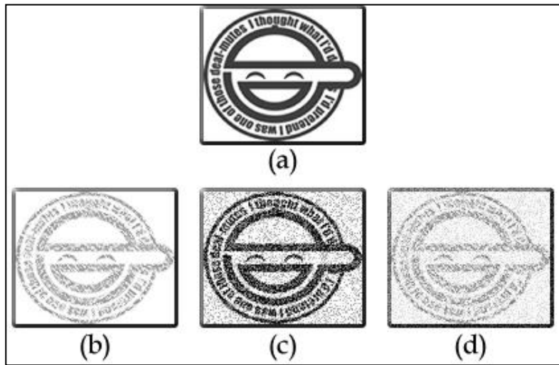
Figura 2. Ejemplo de ruido. a) Imagen original, b) imagen afectada con ruido aditivo, c) imagen afectada con ruido sustractivo, d) imagen afectada con ruido mezclado o mixto.
