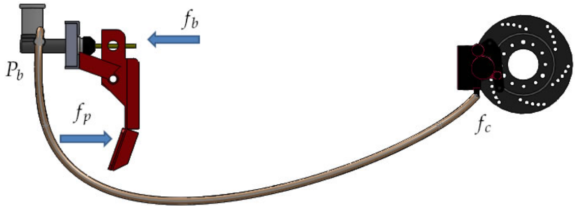
Figura 4.19: Esquema de sistema de frenado
