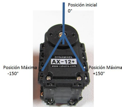
Figura 46.- Giro del motor en el cual se montó la cámara.
