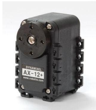
Figura 37.- Motor Dynamixel AX-12.
