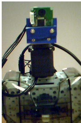
Figura 45.- Montaje de la cámara.
