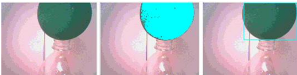
Figura 56.- Funcionamiento del algoritmo de detección de color de la cámara HAVIMO.
