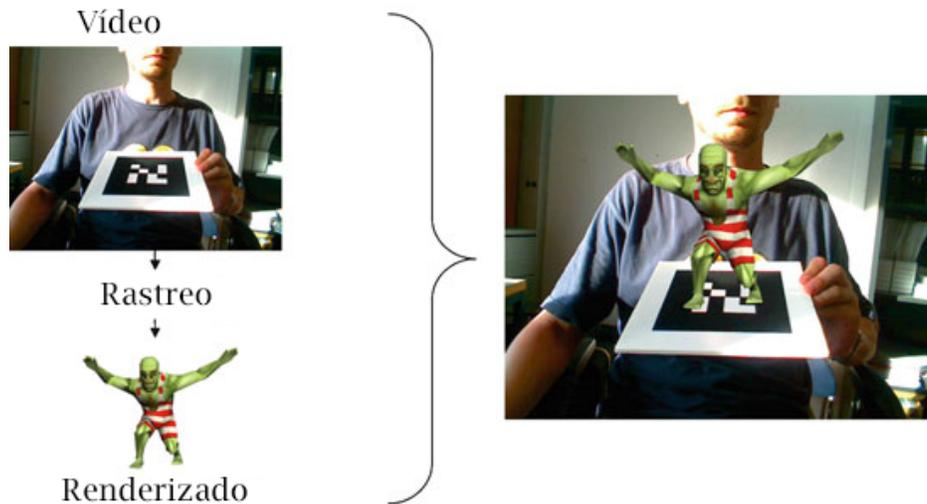
Figura 3.12: El flujo de datos en un sistema de realidad aumentada común. Un mundo real imaginario es entregado por la alimentación de video del sistema y procesada por algoritmos de seguimiento basados en visión. Para alinear los datos reales y virtuales, los datos de seguimiento derivados se les ha aplicado una transformación del contenido virtual. Por último, la prestación se superpone en la parte superior de la secuencia de video.
