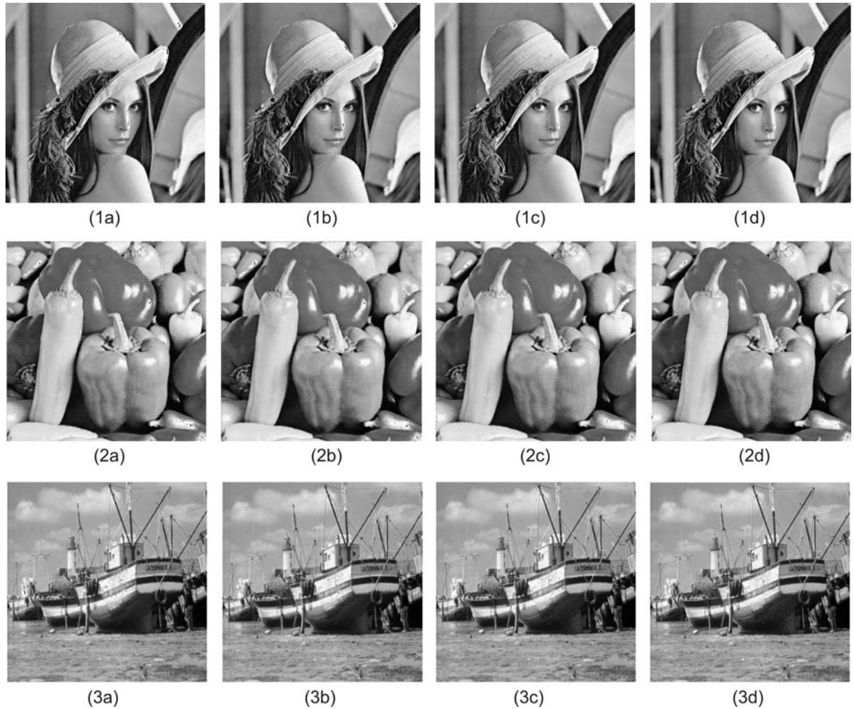
Figura 5.3. Resultados de aplicar la TM y VQ sobre las imágenes de prueba; (a) 64 vectores de reconstrucción, (b) 128 vectores de reconstrucción, (c) 256 vectores de reconstrucción, (d) 512 vectores de reconstrucción.
