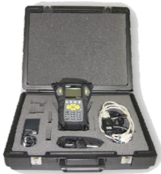
Figura 2.16. Colector de datos y analizador del FFT portátil bi-canal.
