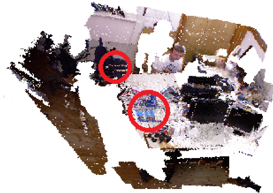
FIGURA 9.3: Mapa 3D construido de la secuencia 1. Los círculos rojos señalan inconsistencias visibles en el mapa.
