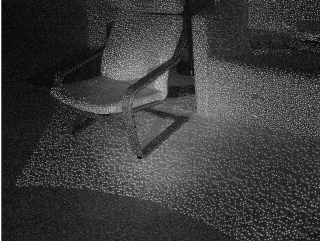
FIGURA 4.2: Imagen IR proporcionada por el sensor Microsoft Kinect donde se aprecia el patrón IR proyectado por el emisor láser.
