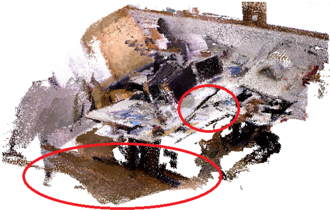
FIGURA 9.8: Mapa 3D construido de la secuencia 2. Los círculos rojos señalan inconsistencias visibles en el mapa.
