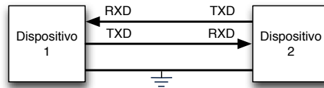
Figura 3.14: Circuito eléctrico del protocolo UART
