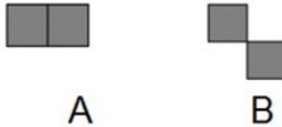
Figura 3.6: Pixeles adyacentes: A) Adyacentes por frontera, B) adyacentes por esquina.
