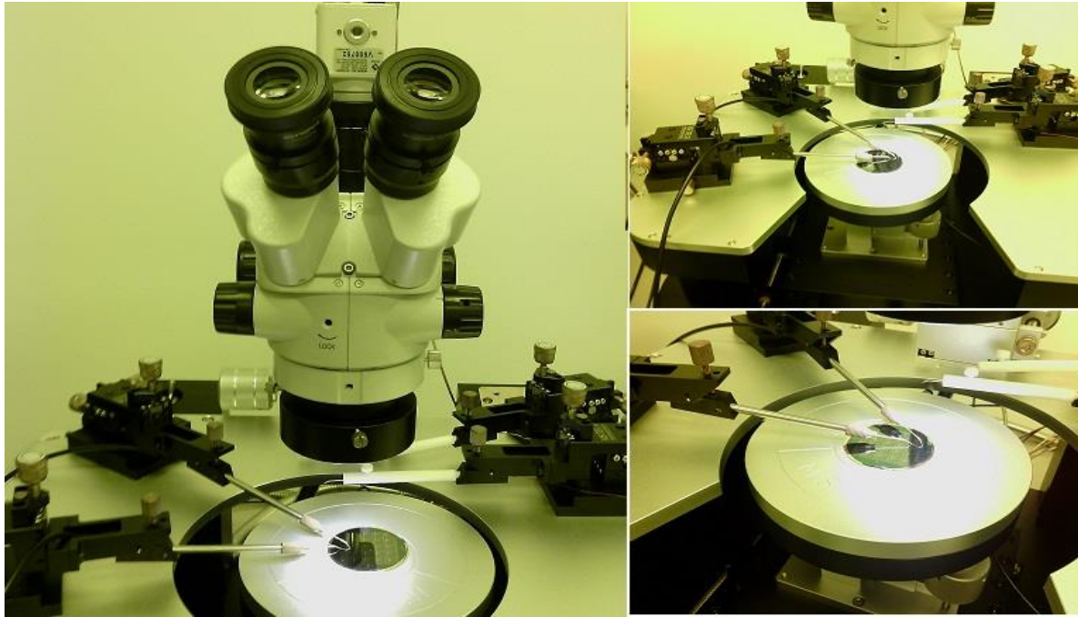
Figura 5—20 Estación de puntas de prueba.
