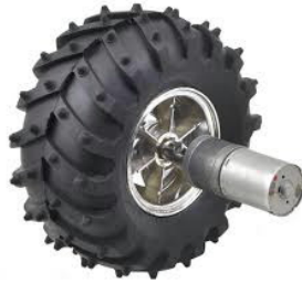
Figura 6-4: Conexión de los motores y las llantas del DAGU
