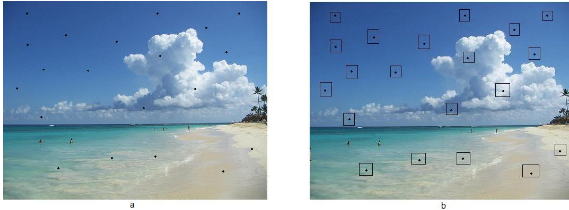
Figura 4.2: (a).-Para la descripción de las sub-imágenes, 300 píxeles de imagen son aleatoriamente seleccionados uniformemente. (b).-Para lograr una segmentación automática de la imagen, alrededor de cada uno de los 300 píxeles se abre una ventana cuadrada de tamaño M \times N . En esta figura se muestran solamente 20 puntos como ejemplo.
