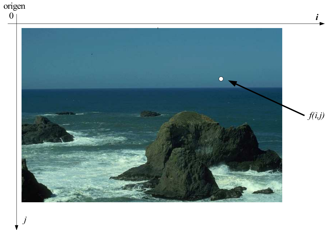
Figura 7.1: Convenio de ejes utilizado para la representación de una imagen digital.
